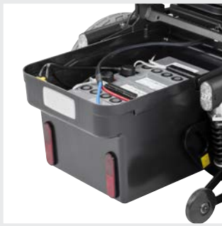
Servicefreundlichkeit Einfache Batteriewartung durch ausziehbaren Batteriekasten
