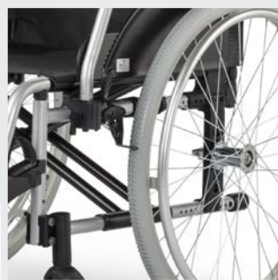
Meilleure stabilité grâce à l'utilisation de doubles ciseaux
