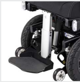
Le repose-jambes central permet un angle des genoux de 90°
