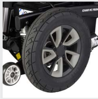
Roues motrices 14" à l'avant
