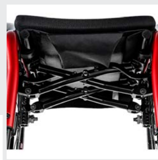
Doppelkreuzstrebe für ein starrahmenähnliches Fahrverhalten
